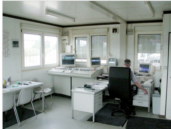
Sand- und Kieswerk im Raum Köln. Leitstand mit MEVIS, MEBAS, MEWAA und MEDOS
